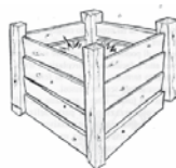
Con un cassone in legno, ottenuto assemblando dei bancali o costruito "in casa" con tavole o paletti in legno chiodati tra loro.
