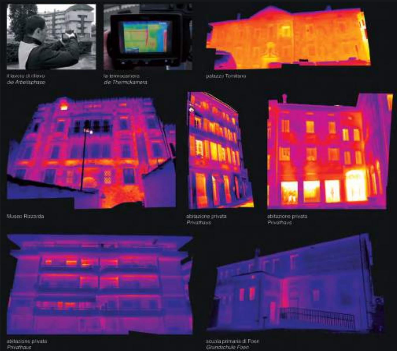
Fig. 5 - L'acquisizione delle dispersioni delle facciate attraverso immagini termografiche
