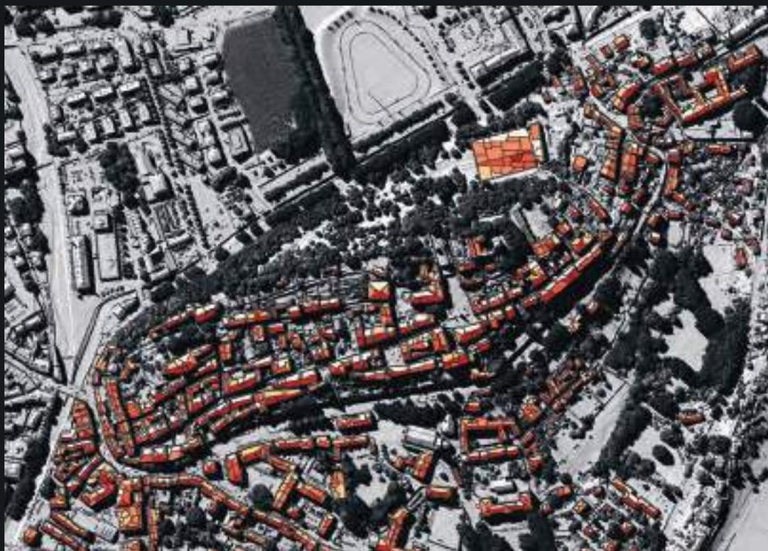
Fig. 7 - Stima della potenzialità fotovoltaica delle coperture del centro della città di Feltre.
